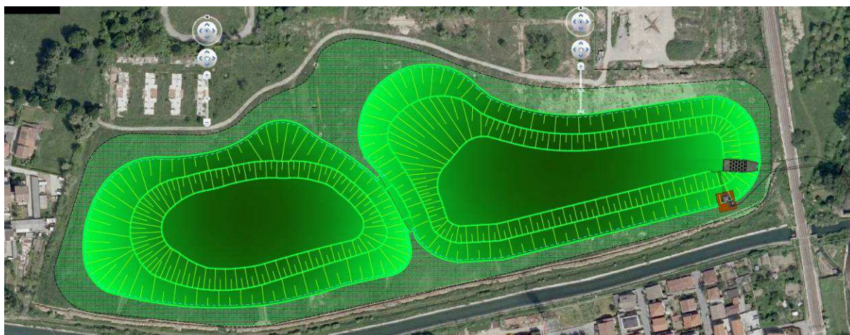
Figura 91 - Configurazione planimetrica dell'invaso di Paderno Dugnano
